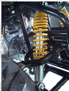
**Amortecedores dianteiros:** todos os modelos possuem suspensão com braço duplo e amortecedores com regulagem de altura.
