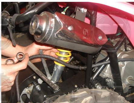
1. Cheque e, se necessário efetue o reaperto dos parafusos e porcas das rodas: para os modelos de 50cc a 150cc, as rodas dianteiras e traseiras contam com 3 parafusos e uma porca central de eixo; para os modelos de 150cc a 300cc, as rodas dianteiras e traseiras contam com 4 parafusos e uma porca central de eixo.
