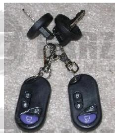
**ATENÇÃO:** Modelos com alarme consomem bateria com o quadriciclo desligado.
